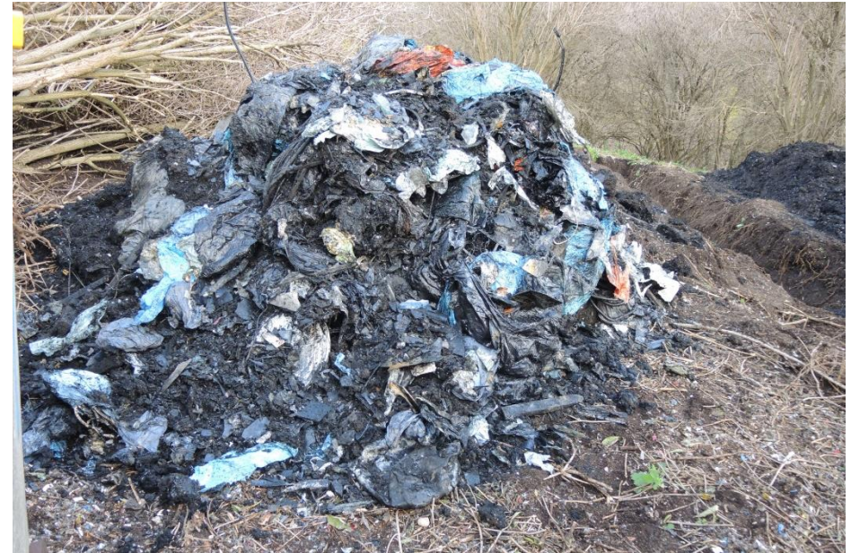
Abb. 22: Sperrmüll aus Schurf A unmittelbar nach dem Ausheben
