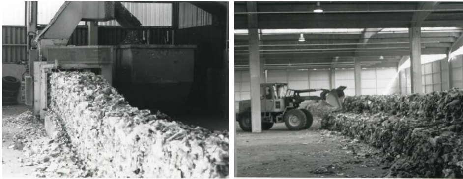
Abb. 3: Müllhygienisierungsanlage Frojach-Katsch: Kantballenpresse (li.) zur Kompaktierung von Siebresten , gelagert im (heutigen) ASZ.
