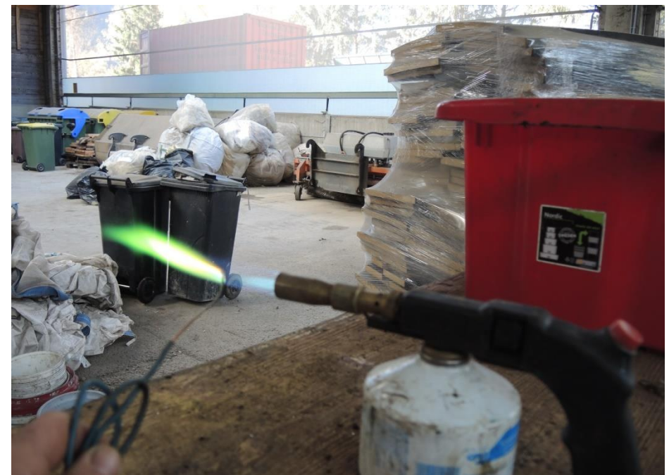
Abb. 20: Fallweise Anwendung der „Beilsteinprobe“ bei der Sortierung von Kunststoffen ( https://de.wikipedia.org/wiki/Beilsteinprobe )
