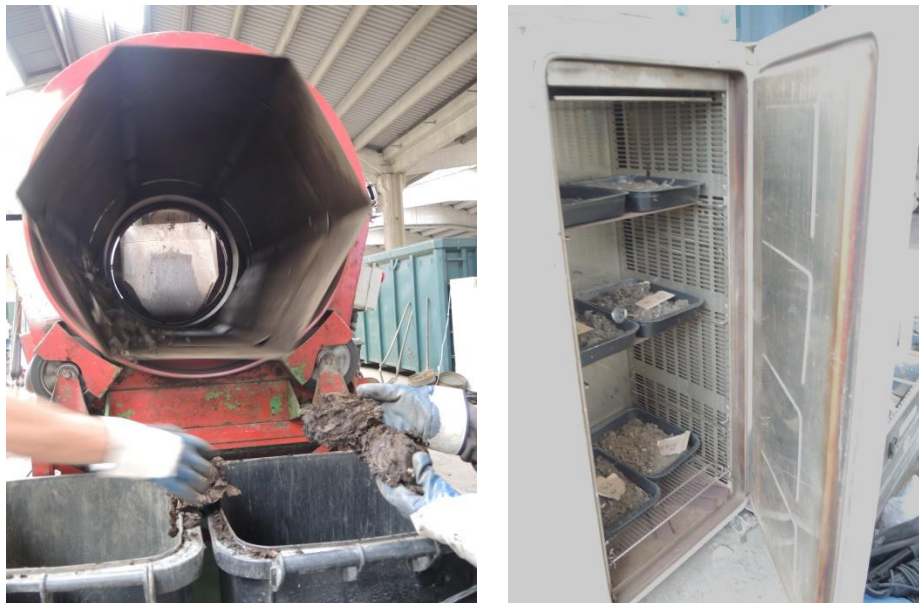
Abb. 19: Siebung der Proben (hier: Siebrest 2) bei 10 mm; Bestimmung des Wassergehalts einzelner Siebklassen im Trockenschrank
